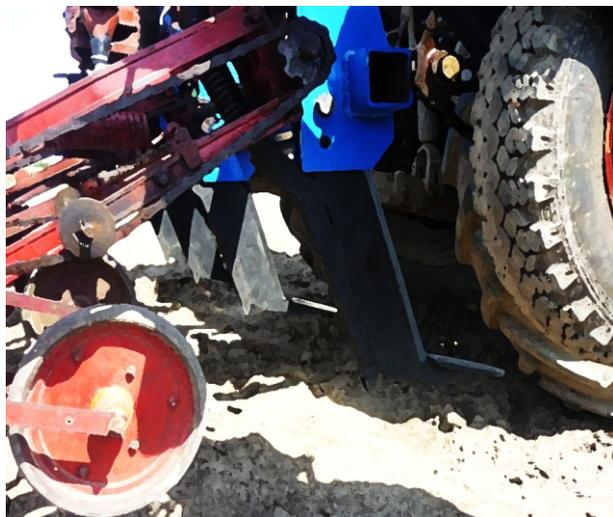
Рисунок 1 – Размещение чизельных лап на раме прототипа сеялки
