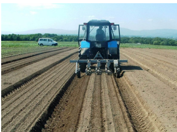
Рисунок 2 – Посев овощей на гряде 1,8 м сеялкой СТВ-5
