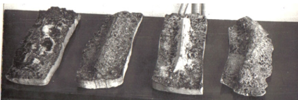
Рисунок – Гипсовые слепки по результатам исследований (слева-направо: расчлененные активные; сплошные прямые; клиновидные с углом при вершине 60°; полукруглые прямые)
