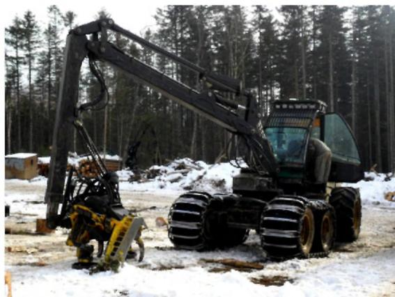
Рисунок 1 – Харвестер с валочно-сучкорезно-раскряжёвочным рабочим органом
