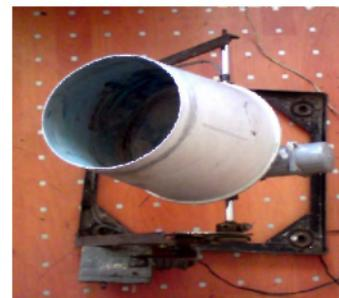
Рисунок 1 – Дражиратор, используемый в опытах
