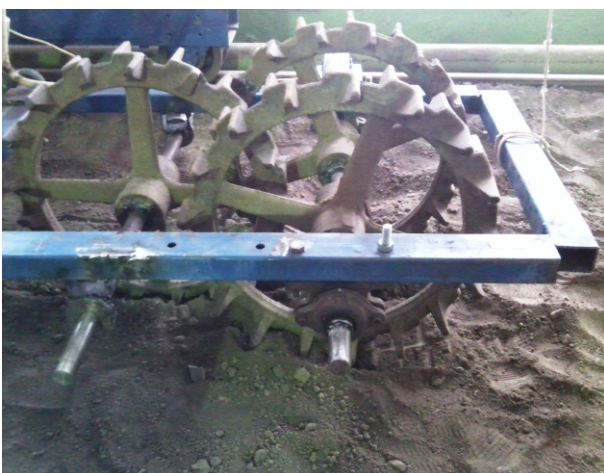
Рисунок 1 – Испытания кольчато-шпорового катка ЗККШ-6
