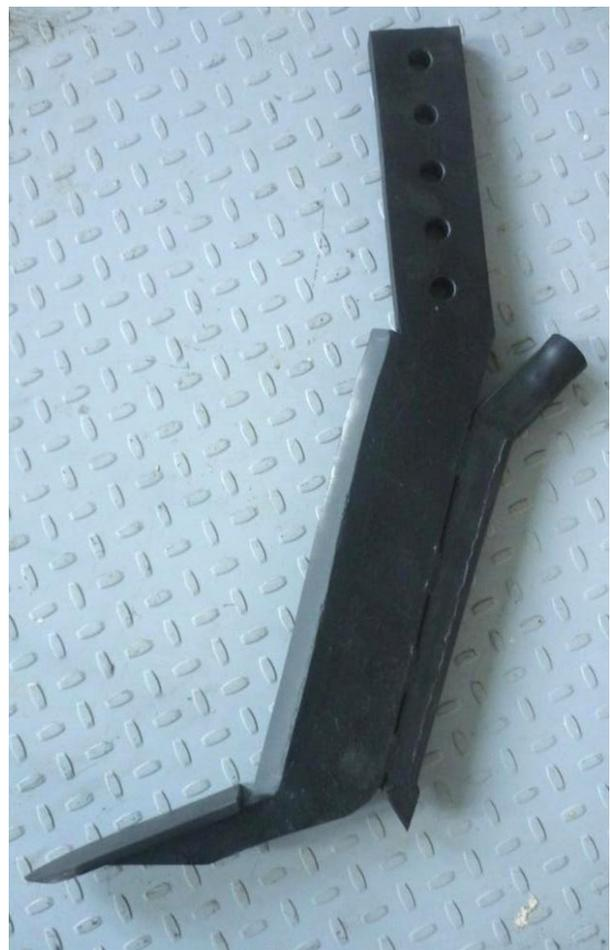
Рисунок 3 – Общий вид чизельной стойки с лапой и тукопроводом
